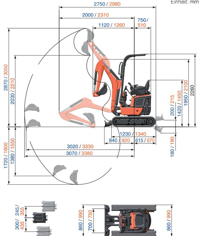
\* Die technischen Daten über den Arbeitsbereich der Maschine wurden mit dem Kubota original-Tiefkoffel ermittelt, ohne Schnellwechseleinrichtung.
