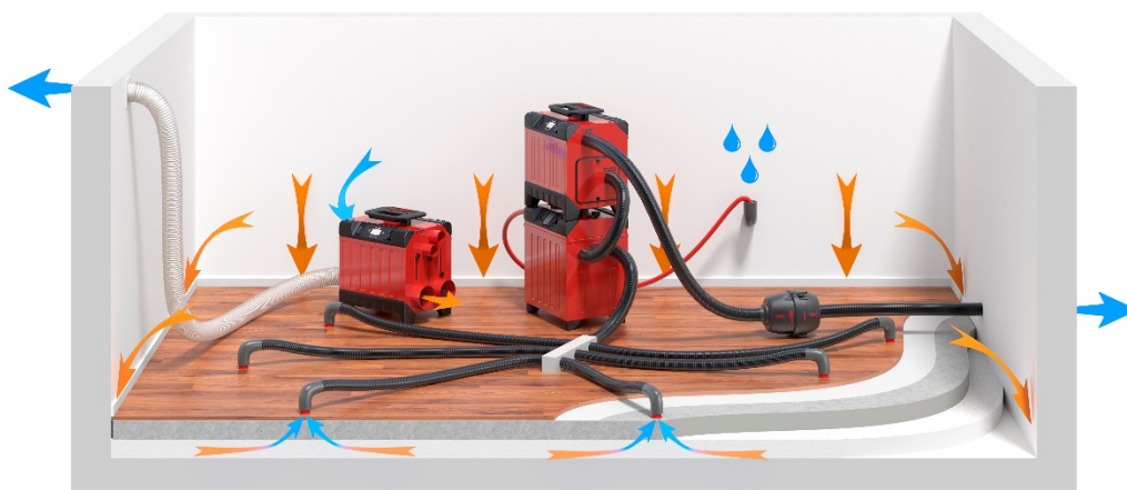
Vakuumtrocknung. Der Trockner trocknet die Raumluft und die Turbine saugt Luft aus der Konstruktion und leitet sie ab. Durch den entstehenden Unterdruck in der Konstruktion wird trockene Luft in die Konstruktion gesaugt.
