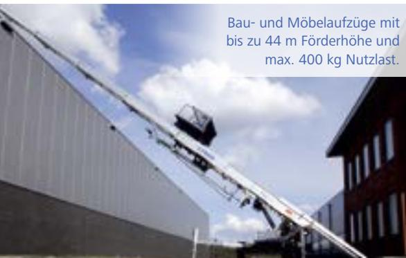
Bau- und Möbelaufzüge mit bis zu 44 m Förderhöhe und max. 400 kg Nutzlast.
